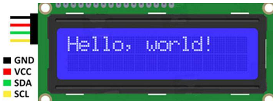
Рис. 1. Подключение модуля ЖКИ к Ардуино
