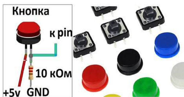
Рис. 1. Схема подключения тактовой кнопки к микроконтроллерной плате
